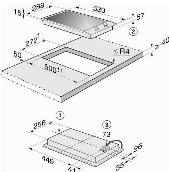
Dim. d'encastrement (HxLxP) : 73-95x272x500 mm
