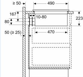
En cas d'installation directement contre des murs extérieurs qui ne sont pas isolés ( $\mu \geq 0,5 \text{ W/m}^2 \cdot \text{°C}$ ), nous recommandons d'utiliser des configurations de recyclage partiellement ou totalement gainées.
