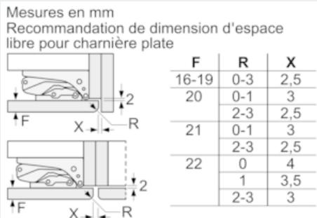
Les dimensions d'espace libre recommandées dans le tableau doivent être respectées afin d'assurer une ouverture sans collision des portes de l'appareil, et d'éviter ainsi d'endommager les meubles de cuisine.
